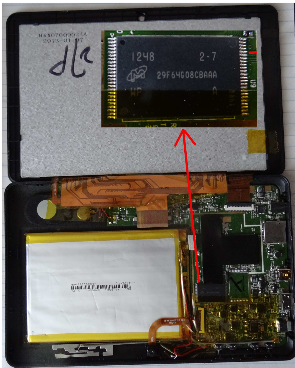
Obrázek 4.1: Rozložený tablet s detailem paměťového čipu
